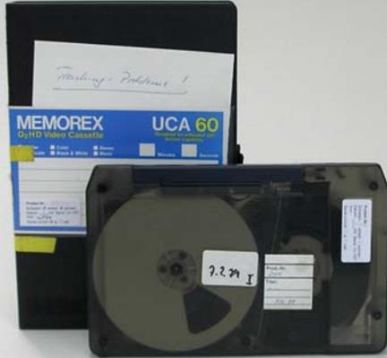
*U-matic Kassette mit Plastikhülle. Ursprünglich für den Konsumermarkt konzipiert, entwickelte sich U-matic zum Standardband der Fernsehanstalten.*
